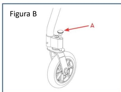
2. Para desplegar el Nimbo, mire hacia el extremo abierto, presione los pasadores de empuje, incline el andador para que descansa sólo sobre sus patas traseras y empuje las patas delanteras hacia las traseras.
