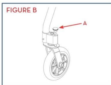
2. Pour déplier le Nimbo, faites-le face à l'extrémité ouverte, appuyez sur les goupilles de poussée, inclinez le déambulateur de manière qu'il repose uniquement sur ses pieds arrière et poussez les pieds avant vers les pieds arrière.
